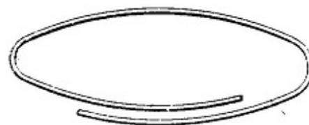
FIG. 36. — Le commencement et la fin d'une spire de bobine, voisins l'un de l'autre, mais séparés électriquement par la self-induction de la spire, forment un condensateur parasite, qui s'étend, en réalité à toute la longueur du fil et donne une « capacité propre » à la bobine.
